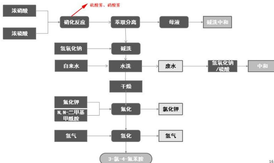
图 2-9 3-氯-4-氟硝基苯工艺流程
