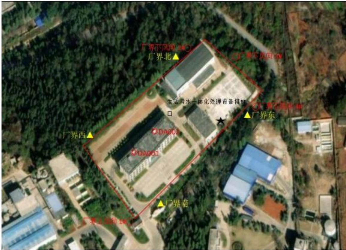
○表示无组织废气检测点位，●代表有组织废气检测点；▲表示厂界环境噪声检测点位；★表废水监测点位
